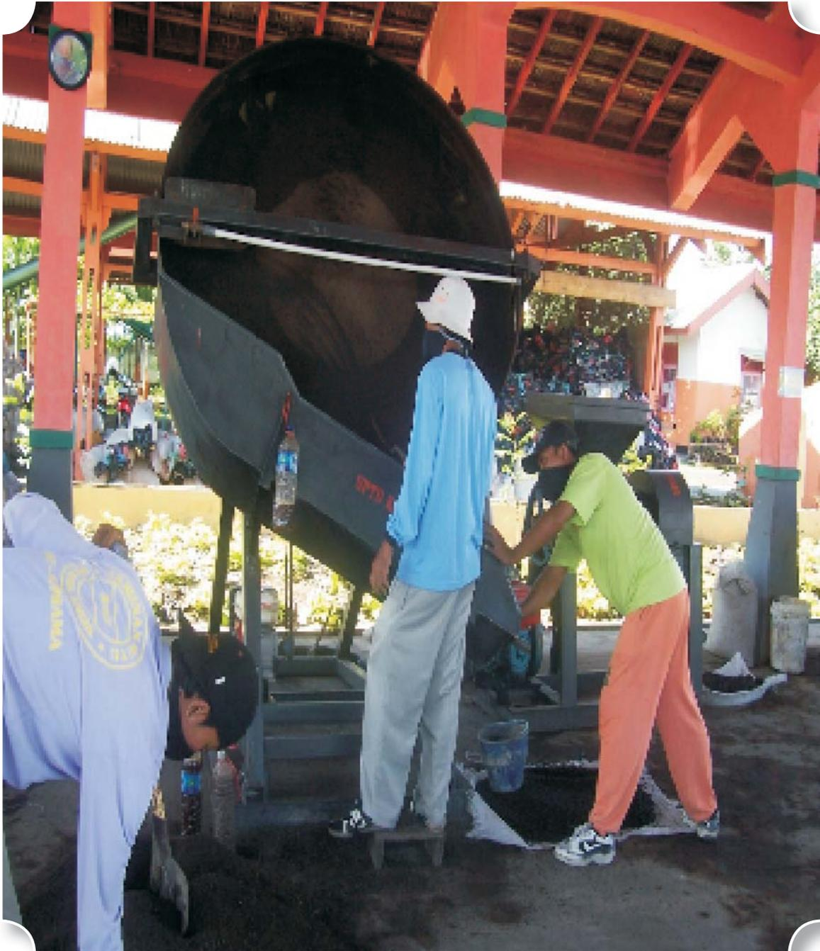
Gambar 3. Pembuatan pupuk kompos granul dengan rotating *disc machine*
